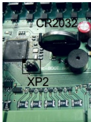
Рисунок 5 – Встроенный элемент питания контроллера «Saturn-PLC»
