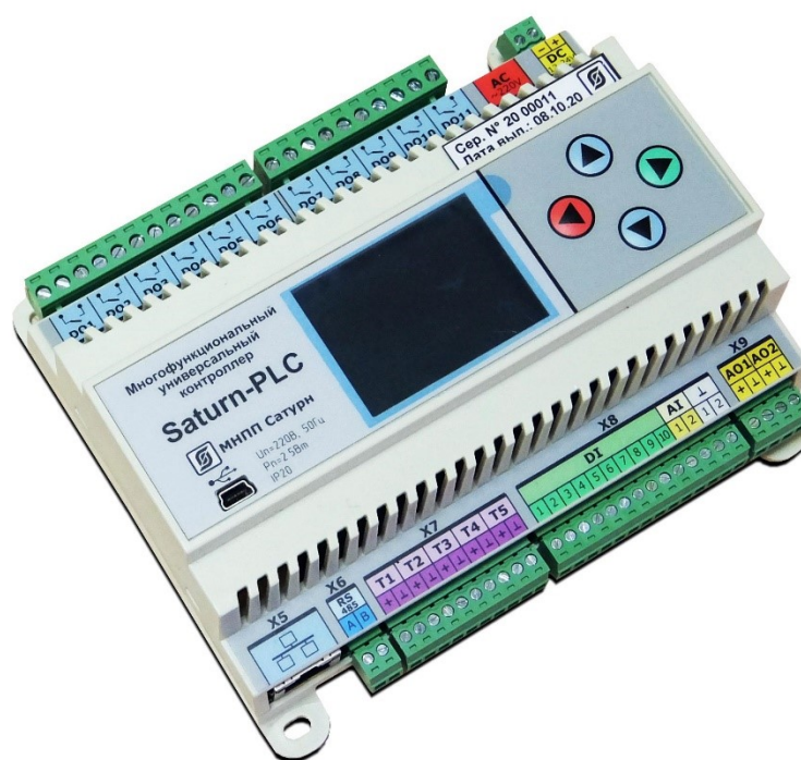
Рисунок 1 - Внешний вид контроллера «Saturn-PLC»
